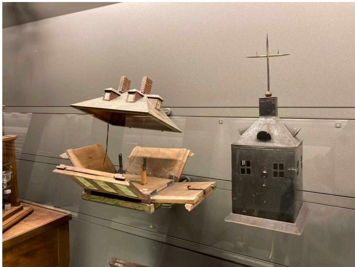
CNAM Paris Maison en Tôle pour les essais sur les effets de la foudre, fin XVIII e sc Inventaire 1960-2
